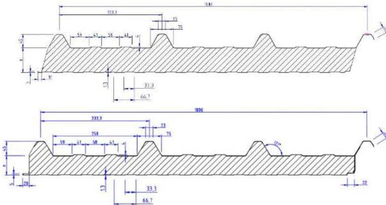
**Concernant les éventuels autres profils de couverture que ne seraient pas référencés spécifiquement ci-avant**, la société JORISIDE peut donner son accord au cas par cas à d'autres profils de couverture (incluant les Profils en Tôles acier Nervurée et les panneaux sandwichs avec mousse PIR), pour autant qu'ils satisfassent aux contraintes suivantes qui constituent un prérequis indispensable :
